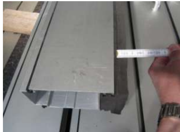
Bild 5-10: Ausführung der Bodenabdichtung
