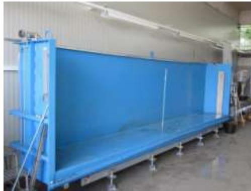
Prüfbox vor dem Einbau des Hochwasserschutzsystems
