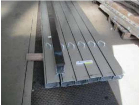
Bild 5-7: Damm balkenelemente, gelagerte Profile
