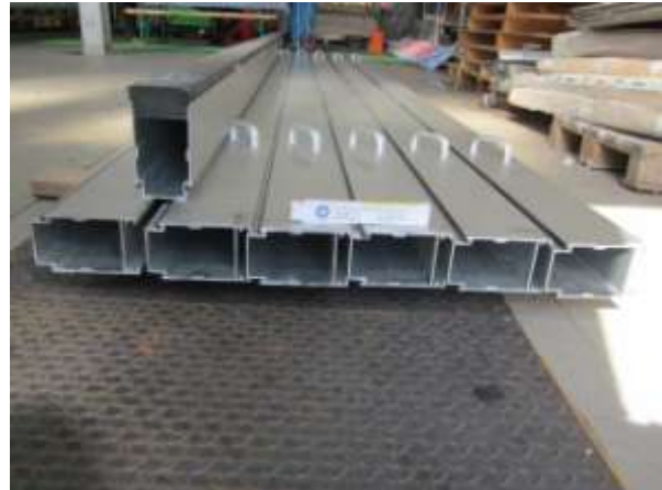
Bild 5-8: Damm balkenelemente, gelagerte Profile
