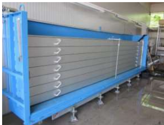
Prüfbox nach dem Einbau des Hochwasserschutzsystems
