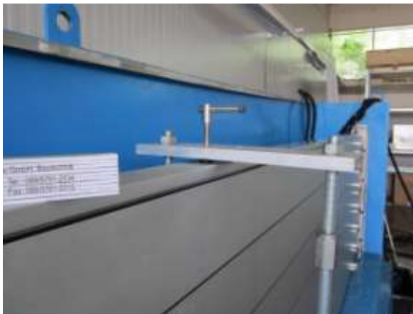
Bild 6.2-3: Fixierung der Dammbalken mittels Vertikalspanner bei „Mittelstütze“
