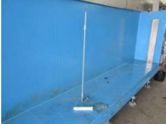
Bild 6.2-1: Einbau „Mittelstütze“, die nur zur Vertikalverspannung dient
