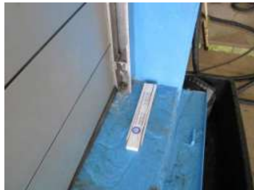
Bild 6.3-2: Wasseraustritt in den Ecken der Sohlendichtung, linke Seite deutlich weniger
