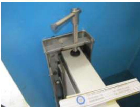
Bild 6.2-5: Fixierung der Dammbalken mittels Vertikalspanner (Knebelschraube, Anpressplatte) sowie horizontal durch Press- und Dichtschieber
