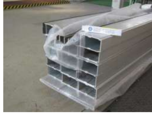
Bild 6.2-2: Dammbalkenelemente, gelagerte Profile
