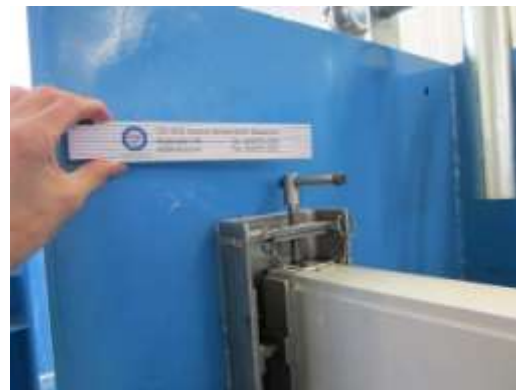
Bild 6.2-6: Fixierung der Dammbalken mittels Vertikalspanner
