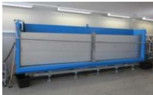
Bild 5-2: U-Aufnahme und Dammbalken mit Vertikalspanner
