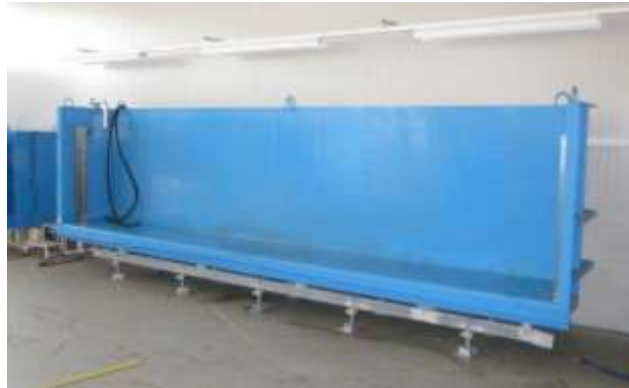
Prüfbox vor dem Einbau des Hochwasserschutzsystems
