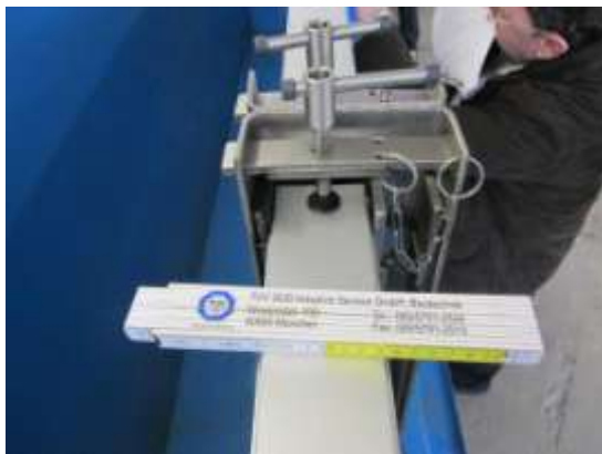
Bild 5-3: Mittelstütze und Dammbalken mit Vertikalspanner
